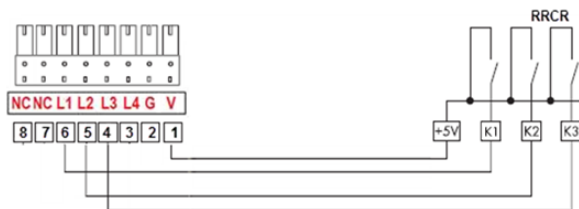
Abbildung 42 – Wechselrichter – FRSE-Anschluss mit 3 Relais
